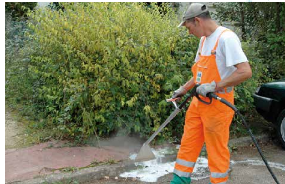
Désherbage thermique par utilisation d'eau chaude additionnée d'amidon de maïs et de noix de coco. Le mélange produit une mousse isolante qui évite un refroidissement trop rapide des herbes traitées et permet ainsi à la chaleur d'être plus efficace
