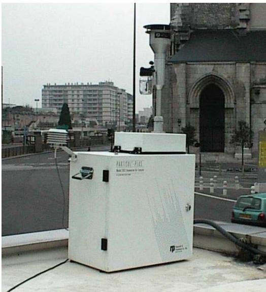
L'appareil utilisé pour les campagnes réalisées par LIG'AIR est un préleveur bas débit Partisol Plus de Rupprecht & Pataschnick équipé d'une tête PM10 (voir photo). Ce préleveur est programmable en durée et débit de prélèvement. La régulation du débit d'aspiration est assurée par un régulateur électronique de débit volumique.
