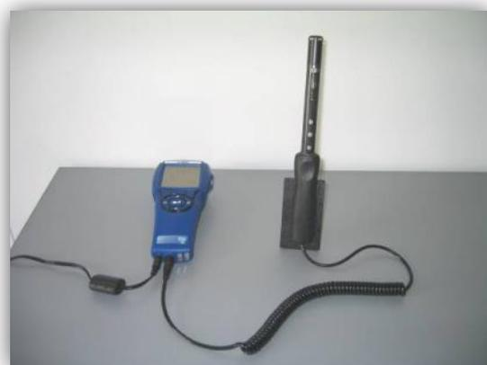
Figure 6 : appareil de mesures des paramètres de confinement.
