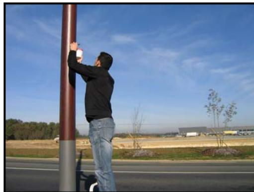
*Photo 2 : pose d'un tube passif*
