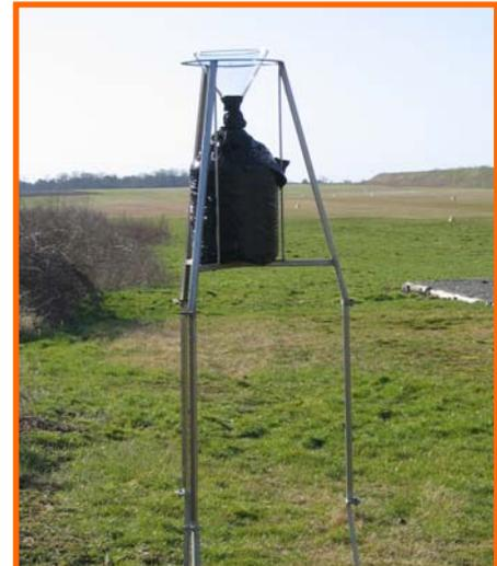
Photo 1 : Prélèveur passif type Jauge Owen sur trépied
