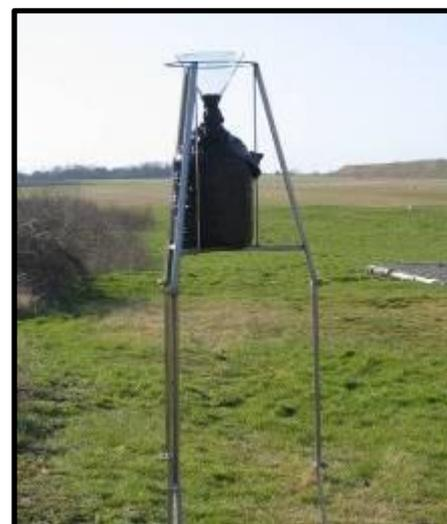
Figure 2 : Préleveur passif de type Jauge Owen sur trépied
